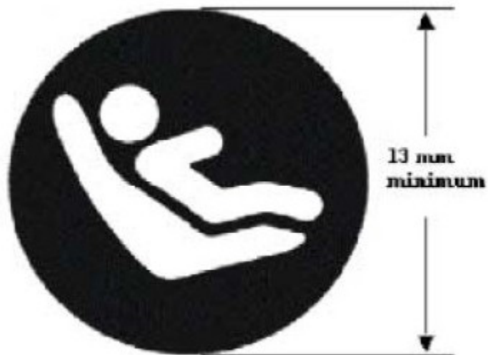
Figure 10 — Symbole du dispositif universel d'ancrages d'attaches inférieurs
